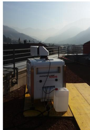
Strumentazione: 15 stazioni al suolo (punti coloranti nella mappa); profilatore termico (MTP5-HE, presso aeroporto); SODAR (immagine centrale, installato sul tetto del termovalorizzatore) e Doppler Wind-LIDAR (immagine a destra).
